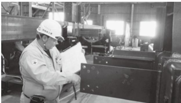
柱の寸法精度を計測している写真。このほか外観チェックや溶接部検査などを行います。
